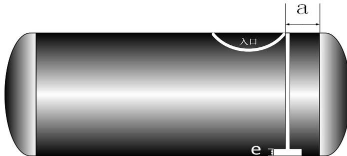
图 B.4 卧式金属罐计量口 (入口) 位置示意图
