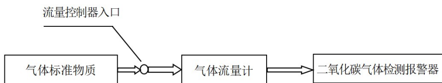
图 2 扩散式二氧化碳气体检测报警器校准用设备连接示意图
